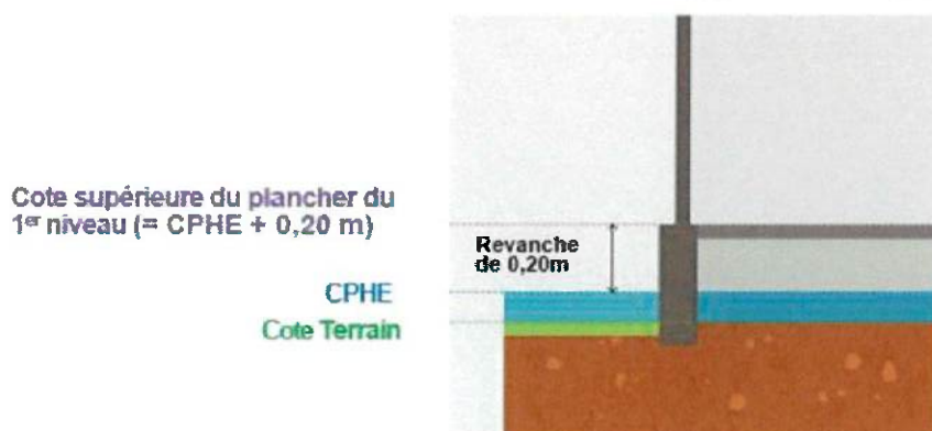
Fig. 5. Illustration de l'implantation d'un bâtiment en zone de débordement de cours d'eau (Mayane, 2018)
